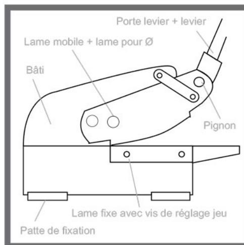
**Le Modèle à tôle L est une cisaille manuelle d'atelier permettant tous les cisailages courants.**
